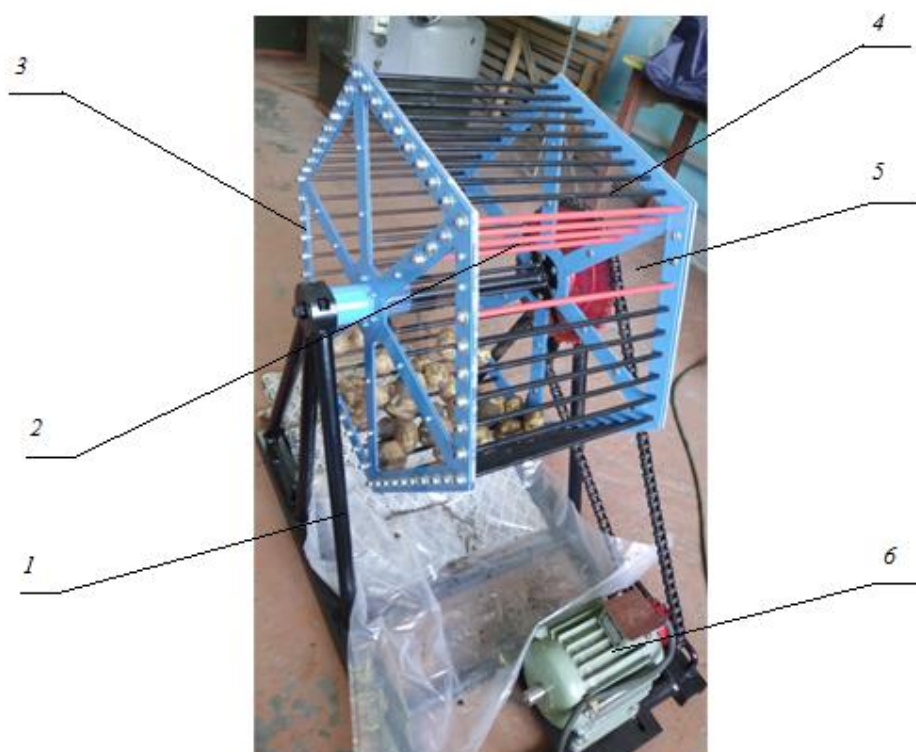
Рисунок 1. Предлагаемый имитатор: 1 – основание; 2 – лопасть; 3 – корпус; 4 – прутки; 5 – окно; 6 – электродвигатель.
